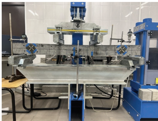
Рис.20а. Железобетонная балка С7 на II стадии НДС
