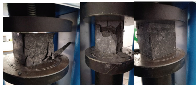
Рисунок 3. Кубический образец после разрушения (Тагарист).
