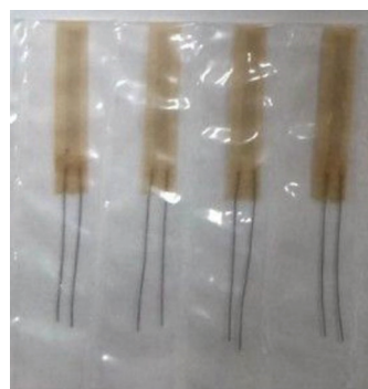
Рис.14. Проволочные петлевые тензорезисторы
