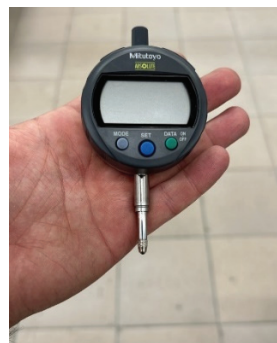
Рис.13. Индикатор часового типа электронная для измерения прогиба балки
