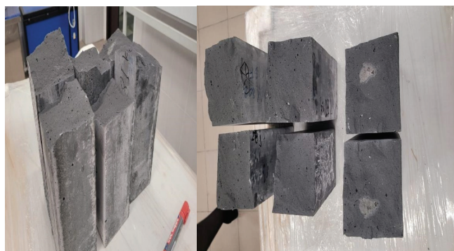
Рисунок 7. Вид призматических образцов после разрушения (Тагарист).
