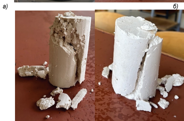
Рис.6. Результаты эксперимента №4: а) вид образца в приборе 3 х осного сжатия, б)в)г) три стороны образца
